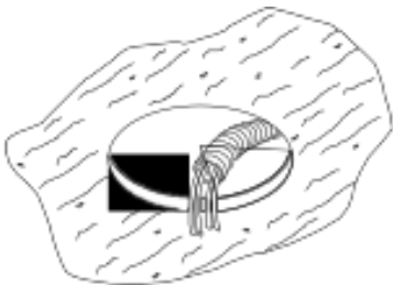
圖3： 切口孔 （圖示：電線置於柔性導管中）
