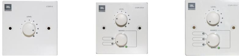
JBL Commercial® CSR系列壁式控制盒可应用模拟直流电压控制音源选择和音量，包括CSR-V、CSR-2SV和CSR-3SV。它配有5类电缆，通用的RJ-45型接头，电缆长度可达1000英尺（305米）。使用CSR系列壁式控制盒，您可以远程选择音源，也可以控制CSM控制器的音量。
