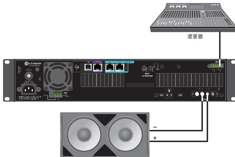
图 21 系统接线桥接模式
