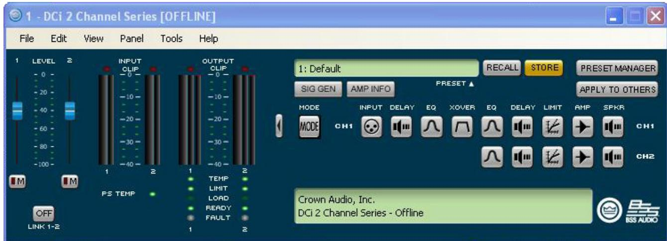
图 16 选中“Y 1+2”框时，输出 Ch.1 和 Ch.2 均由输入 Ch.1 驱动，而输入处理也照此安排。
